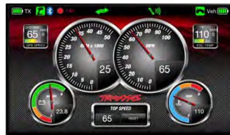
El tablero de instrumentos personalizado de Traxxas Link proporciona datos del rpm, la velocidad, la temperatura y el voltaje en tiempo real.
