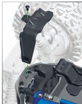
Configuraciones de fábrica de la base de convergencia Delantero: 0 grados Trasero: 2,5 grado de convergencia en cada lado
